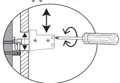
Adjustment that allows you to bring the vanity closer to the wall. Vis de réglage pour rapprocher le meuble-lavabo du mur.
