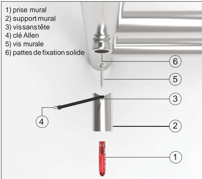
Étape 1 : Sélectionnez la position de montage désirée, assurez-vous que le mur est suffisant pour prendre les points de fixation des rails, c'est-à-dire les points d'ancrage doit être solidement fixé à un goujon ou à une maçonnerie. Il n'est pas recommandé que l'appareil soit installé sur une cloison sèche.
