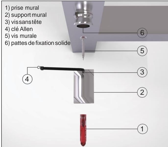
Étape 1 : Sélectionnez la position de montage désirée, assurez-vous que le mur est suffisant pour prendre les points de fixation des rails, c'est-à-dire les points d'ancrage doit être solidement fixé à un goujon ou à une maçonnerie. Il n'est pas recommandé que l'appareil soit installé sur une cloison sèche.
