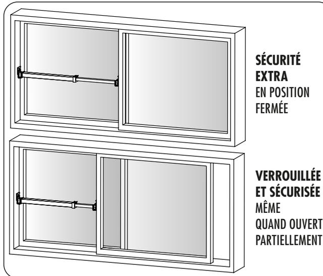
Le levier de dégagement permet à la barre plus étroite de se télescoper dans la barre plus grande. Maintenez ce levier enfoncé pour ouvrir votre fenêtre tout en laissant la barre de sécurité en place.
