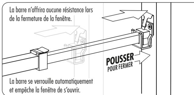
La barre se verrouille automatiquement et empêche la fenêtre de s'ouvrir.
