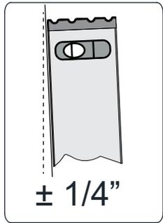
1/4" Ajustement maximum pour Out-Of-Plumb sur la paroi charnière
