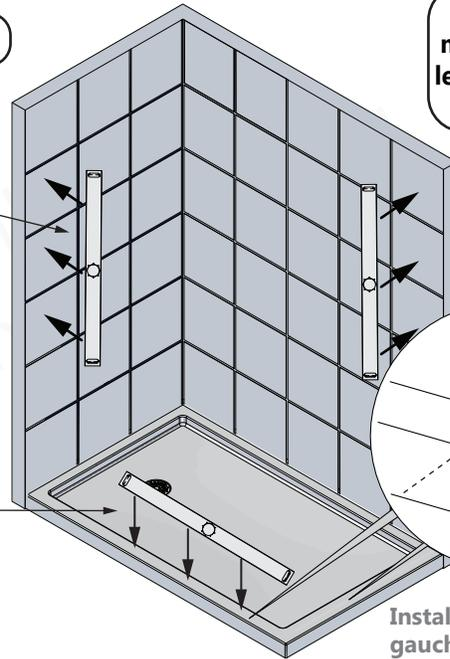
1/2" Ajustement maximum hors d'aplomb dans le canal en U sur le mur du panneau de retour
