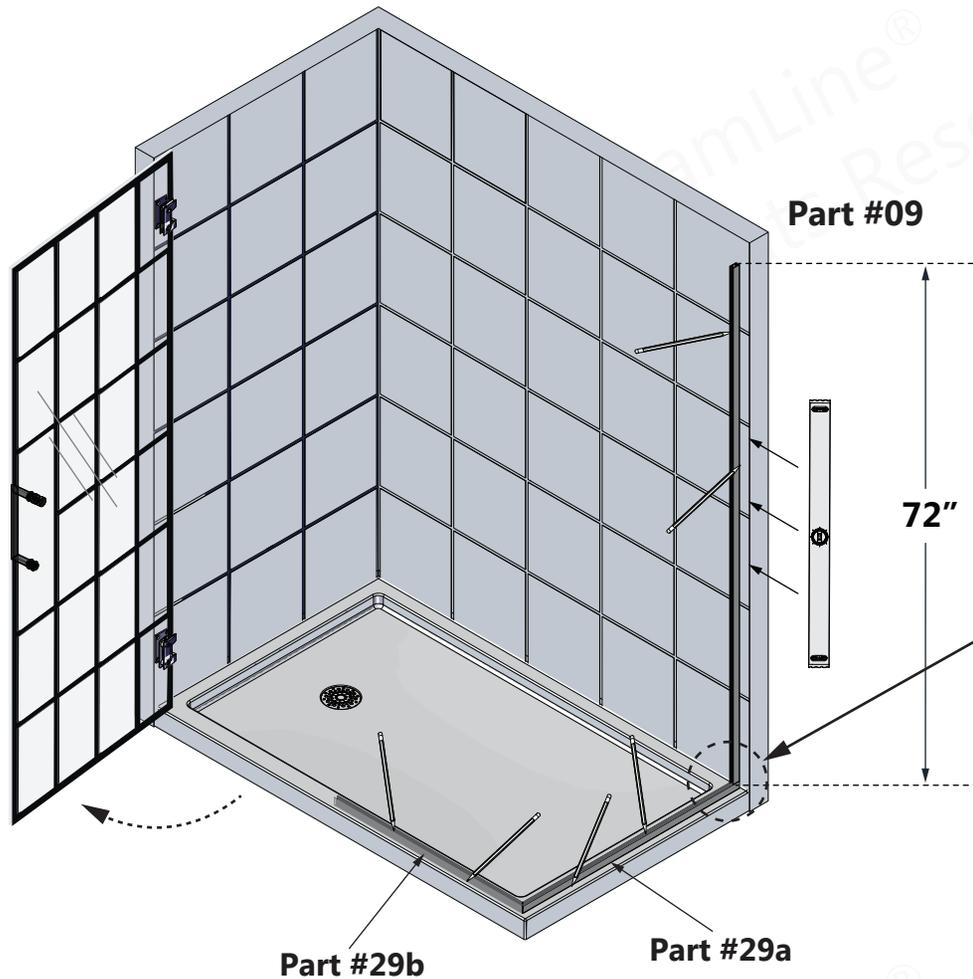
**Installez le profilé en U vertical sur le profilé en U inférieur**
