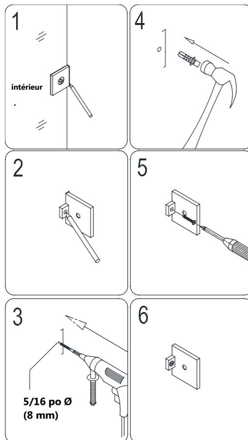
5. Remettez les **Panneaux Vitrés Fixes (N° 01)** et **(N° 03)** en position requise, assemblez les **Fixations Murales (N° 14)** et serrez les boulons. Assurez-vous d'utiliser les joints statiques pour protéger la vitre.
