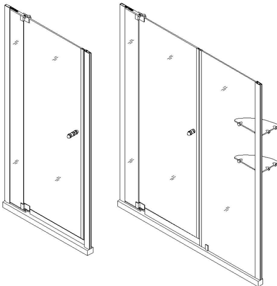
*Illustration d'une installation avec ouverture du côté gauche*
