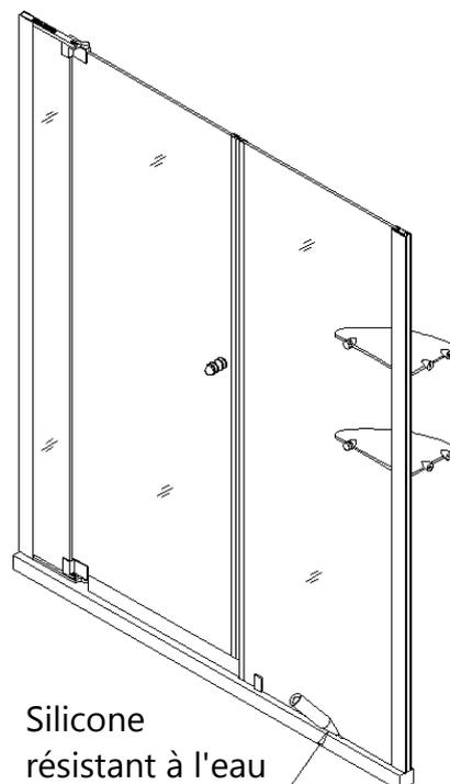
*Illustration d'une installation avec ouverture du côté gauche*
