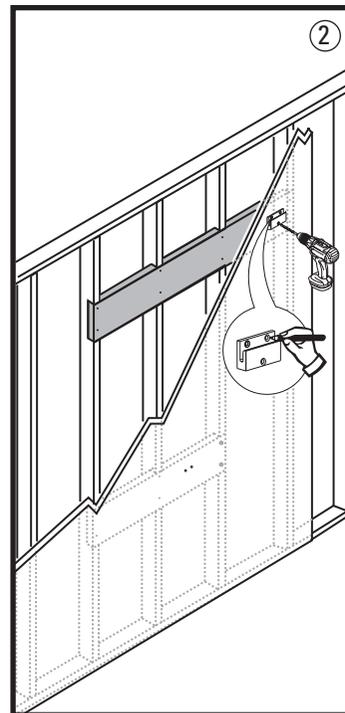
2. Vous devez absolument prépercer toute pièce de bois avant d'y introduire une vis afin d'éviter l'éclatement de celle-ci. Mesurez, marquez et prépercez toujours l'endroit où se fixeront les supports. Consulter un expert pour les vis/boulons à utiliser lors de la fixation à votre construction murale. Les vis fournies ne conviennent pas à tous les types de construction de mur.
