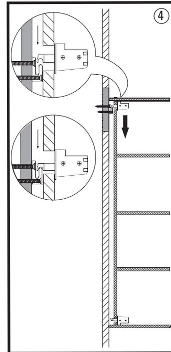
4. Servez-vous des vis de réglage des supports du meuble pour en régler la hauteur et le rapprocher du mur.
