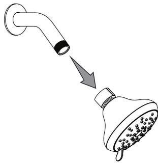
**REMARQUE :** Si votre bras de douche est muni d'une boule à son extrémité, il ne fonctionnera pas avec ce produit et devra être remplacé par un bras de douche standard.
