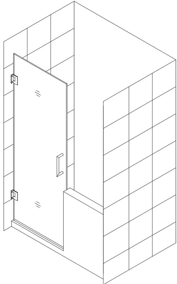
**REMARQUE:** La charnière Unidoor est auto-fermante et pré-ajustée en usine à 8°. La procédure suivante est recommandée pour assurer un alignement adéquat du panneau vitré et de la porte vitrée.
