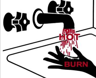
Une température d'eau supérieure à 125°F (52° C) peut causer des brûlures graves ou la mort par échaudures.
