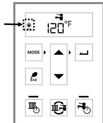
Le témoin de service s'allume quand un robinet d'eau chaude est utilisé et que la chaudière fonctionne.
