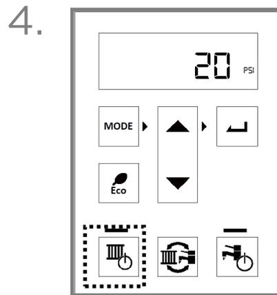
Appuyez de nouveau sur **CC** pour arrêter le chauffage central. La chaudière s'allume et s'éteint en fonction de la température de l'eau détectée.
