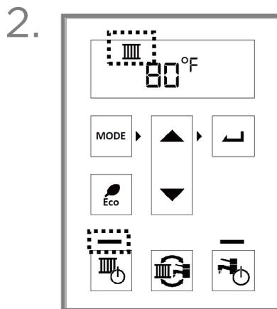
L'icône **CC activé** et la DEL au-dessus du bouton **CC** s'allument.
