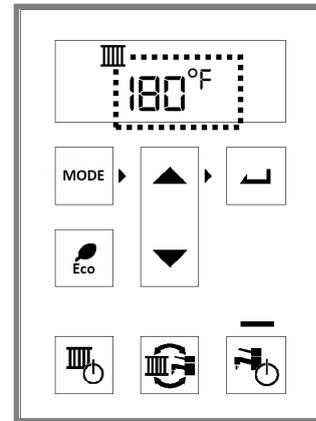
Quand la température clignote à l'écran, le réglage de température CC est accepté et devient active.
