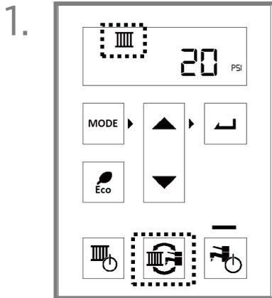
Appuyez sur **Mode d'opération** jusqu'à ce que l'icône de **Chauffage central** s'affiche.
