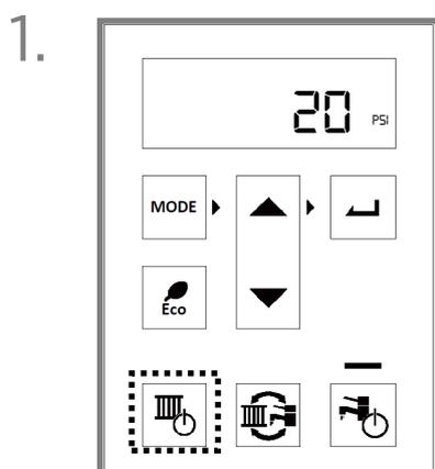
Au mode thermostat, le bouton **CC** n'a aucun effet sur le chauffage. Seul un appel de chaleur depuis le thermostat peut activer la chaudière.
