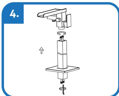
Raccordez les conduites d'eau au corps du robinet à l'aide d'une clé Allen de 8 mm. Attachez la ligne rouge au port rouge et la ligne bleue au port bleu.
