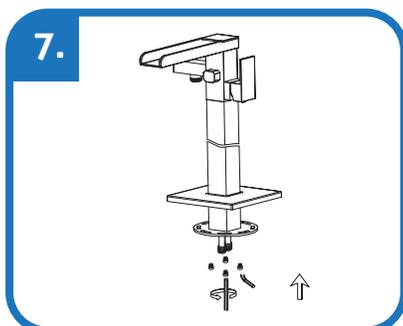
Fixez la plaque de base au tube ascendant à l'aide d'une clé Allen de 3 mm.
