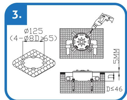
Profondeur N-box murale :  $D < 46\text{mm}$ , N-BOX, plus de 2mm du carrelage. Réglez le niveau à l'aide d'un gradiomètre. Fixez à l'aide d'une vis d'expansion M6, après avoir vérifié l'étanchéité à la pression d'eau, puis cimentez et pavez les carreaux
