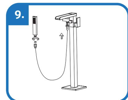
Raccordez la douchette à main au tuyau d'arrosage. Enclenchez le robinet d'eau. Retirez l'aérateur du robinet et rincez. Vérifiez l'étanchéité et les fuites. Réinstallez l'aérateur.
