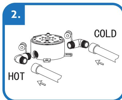
Serrez le raccord à l'aide du ruban teflon pour tuyaux, en raccordant les joints d'eau chaude et d'eau froide, afin d'éviter les fuites.
