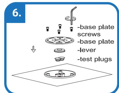
Retirez la plaque de base, l'outil de mise à niveau et les fiches de test du boîtier de montage.
