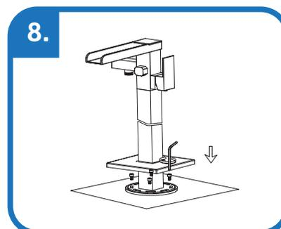
Lubrifiez les joints toriques des conduites d'eau et poussez le robinet vers le bas sur la carte de montage pour installer les conduites d'alimentation. Réglez la position du robinet, puis fixez la plaque de base au support à l'aide d'une clé Allen de 4 mm.
