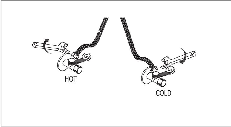
**Étape 7:** Appliquez du ruban de plombier sur le filetage de chaque soupape d'eau. Connectez les deux tuyaux d'eau aux soupapes d'eau respectives et serrez fermement chaque écrou de montage. Ouvrez les soupapes d'eau.
