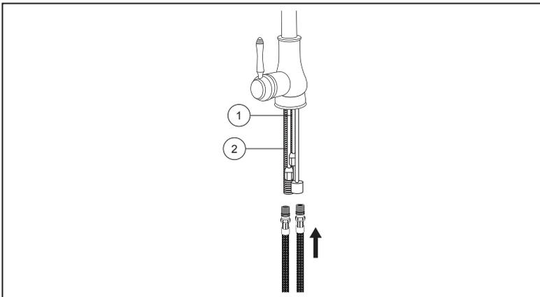
**Étape 2:** La ligne d'eau courte est l'eau CHAUDE, tandis que la ligne d'eau plus longue est FROIDE. Fixez solidement les deux tuyaux d'eau CHAUDE (1) et FROIDE (2) au robinet.
