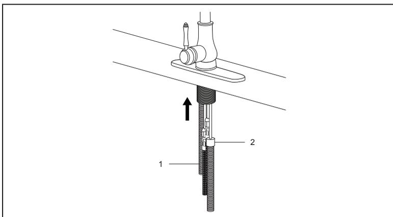
**Étape 4:** Une fois que le robinet est correctement positionné, serrez à fond les vis sur l'écrou de montage pour fixer le robinet en place. Si votre robinet est muni d'un tuyau extensible, fixez son extrémité (1) au convertisseur de ligne (2).
