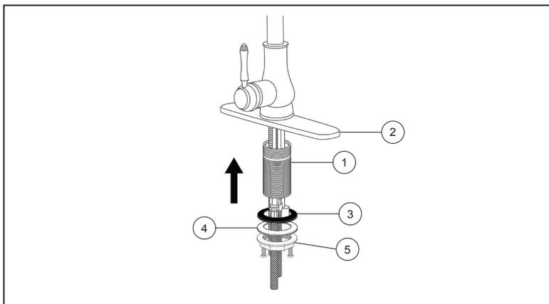
**Étape 3:** Réinstallez la tige (1) et la base (2), le cas échéant, puis installez le robinet à travers le trou de montage du pont. Fixez le joint (3), la rondelle (4) et l'écrou de montage (5) sur la tige.
