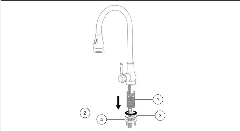
**Étape 1:** Dévissez la tige (1) du robinet (s'il est branché) et mettez-la de côté, avec le joint en caoutchouc (2), la rondelle (3) et l'écrou de montage (4).
