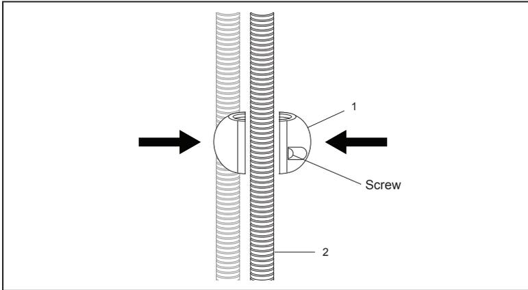
**Étape 5:** Si un poids est fourni en tant que composant de l'assemblage de votre robinet, démontez-le à l'aide d'un tournevis Phillips. Une fois que le poids est séparé, fixez le poids (1) sur le tuyau flexible (2) à l'emplacement souhaité. Remarque: Le poids ne doit PAS entrer en contact avec les tuyaux de robinetterie lorsque la tête du robinet est tirée.
