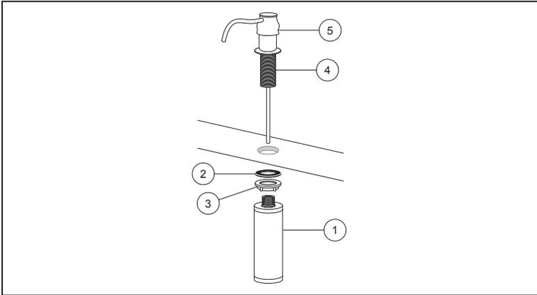
**Étape 1:** Retirez la cartouche de savon (1), le joint d'étanchéité (2) et l'écrou de montage (3) de la tige du distributeur de savon (4). Placez le distributeur de savon (5) dans l'ouverture du pont. De dessous le pont de l'évier, fixez le joint et l'écrou de montage sur la tige du robinet. Avant de serrer et de fixer l'écrou de montage, assurez-vous que le distributeur de savon est correctement positionné.
