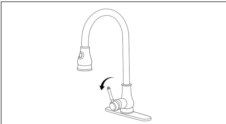
**Étape 6:** Lors de l'installation du robinet, des limailles, des copeaux et d'autres débris peuvent tomber dans les tuyaux de plomberie. Ces débris peuvent endommager les surfaces internes du robinet, ce qui peut provoquer des fuites. Avant d'ouvrir les soupapes d'eau, assurez-vous que la poignée du robinet est en position ouverte (marche) afin d'éliminer complètement les débris.
