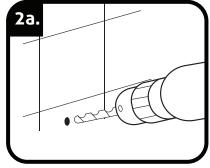
Fixation à une tige de support dans une plaque de plâtre: Utilisez un embout de vissage plus petit que les vis pour prépercer les trous.
