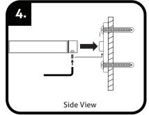
Fixez l'accessoire sur la plaque de montage Utilisez la clé allen fournie pour serrer la tête hexagonale située sur la face inférieure de l'accessoire pour fixer le produit.
