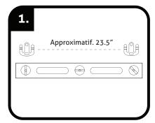
Pour les porte-serviettes: Mesurez la distance entre les plaques de montage à l'aide d'un mètre ruban et d'un niveau. Marquez les points de vissage avec le bout du tournevis ou à l'aide d'un crayon. (Pour les autres accessoires, voir étape 2)
