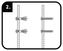
Préparez les trous de fixation pour installer les plaques de montage en suivant l'une des alternatives ci-dessous : A. Fixation à une tige de support dans une plaque de plâtre. B. Fixation aux plaques de plâtre.
