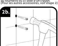
Fixation aux plaques de plâtre: Utiliser une perceuse de taille appropriée pour les chevilles. Avec un marteau, enfoncez chaque cheville dans le mur.
