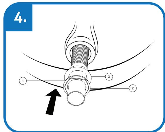
Installez la rondelle (1) et l'écrou de montage (2) sur le corps de la bonde et serrez fermement l'écrou de montage pour vous assurer que le joint 2 (3) est solide et bien droit.
