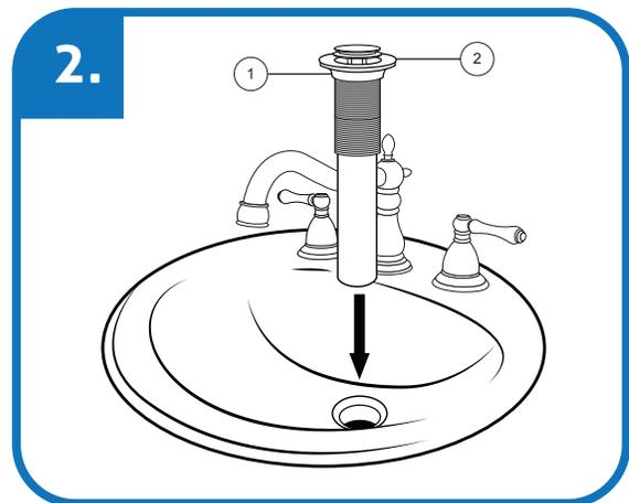
Assurez-vous que le joint 1 (1) se trouve sous la bride (2) de la bonde mécanique puis insérez le corps de la bonde dans le trou de vidange de l'évier.
