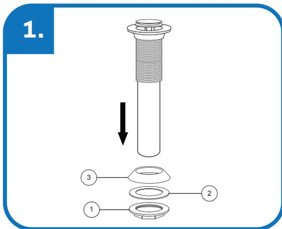
Retirez l'écrou de montage (1), la rondelle (2) et le joint 2 (3) de la bonde mécanique.
