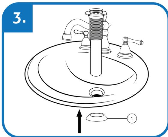
Installez le joint 2 (1) sur le corps de la bonde et assurez-vous que le côté plat du joint est orienté vers le bas.
