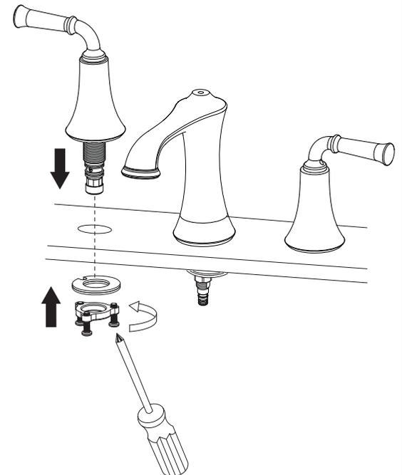
Placer la poignée sur la surface, comme illustré ci-contre. Fixer la poignée en place à l'aide de la troussé de montage et serrer la vis à l'aide d'un tournevis. Répéter les étapes susmentionnées pour l'autre poignée.
