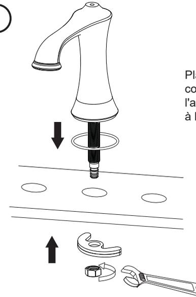
Placer le corps et le joint torique sur la surface, comme illustré ci-contre. Fixer le tout en place à l'aide du joint d'étanchéité et serrer l'écrou freiné à l'aide d'une clé à molette.
