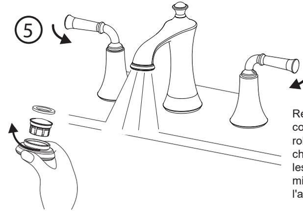
Retirer l'aérateur à la main. Ouvrir complètement la poignée du robinet; ouvrir les entrées d'eau chaude et d'eau froide, puis rincer les conduits d'eau pendant une minute. Installer de nouveau l'aérateur à la main.
