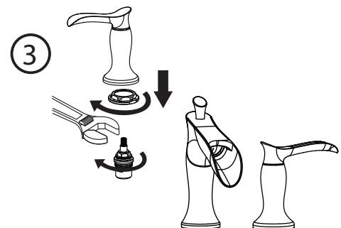
Insérer une nouvelle cartouche dans le logement, visser la base et assembler la poignée à l'aide des vis. Répéter ces étapes pour remplacer l'autre cartouche, s'il y a lieu.
