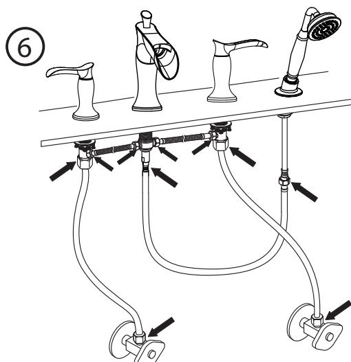
Examiner les raccords aux endroits indiqués par les flèches pour détecter toute fuite et resserrer les raccords, au besoin.
