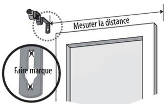
**2** Si les vis vont directement dans les rebords de bois ou les rebords de mur, percez un trou pilote de 1/8" aux marques de crayon. Si vous vissez dans une cloison sèche, suivez les instructions pour l'ancrage de cloison sèche au bas de la page.
