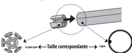
b. Fixez les embouts en poussant l'extrémité du poteau dans l'extrémité de l'insert en plastique jusqu'à ce qu'ils soient bien ajustés. Tourner le faiteau sur la tige pour un alignement correct si nécessaire.
