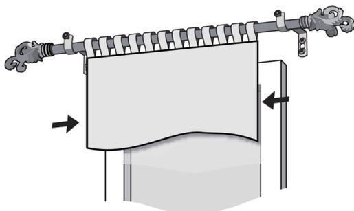
**7** Verrouillez les tiges en position en serrant la vis de nivellement à la main jusqu'à ce qu'elle soit bien serrée. Cela empêchera la tige de bouger.
