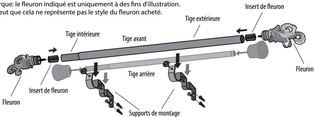
**1** Placez les supports contre le mur aux endroits désirés. Marquez les trous de vis avec un crayon. Assurez-vous que les marques sont de niveau à travers l'ouverture. Montez au moins un support sur chaque tige intérieure et chaque tige extérieure pour empêcher tout mouvement de la tige lors du coulisement du rideau.
