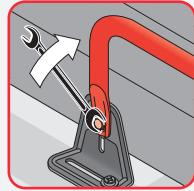
Für die Befestigung der Handläufe sind nur die mitgelieferten Schrauben zu verwenden. Für die störungsfreie und sichere Benutzung der Bodentreppen sind die Schrauben fachgerecht einzuschrauben. Die Handläufe dürfen nur bei zusammengeklappten Bodentreppen eingeschraubt werden.
