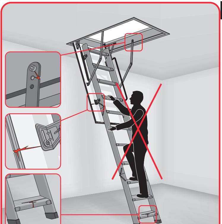
Beschädigte oder defekte Bodentreppen (gebrochene Trittstufe, beschädigte Klappe oder Beschläge) dürfen nicht benutzt werden.
