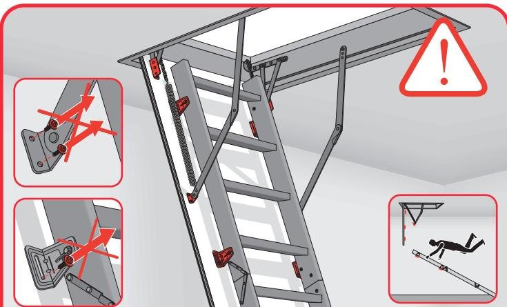
Перед началом эксплуатации лестницы необходимо проверить все соединения болтов, винтов и заклепок. Нельзя пользоваться лестницей, у которой расшатаны болты или гайки.
