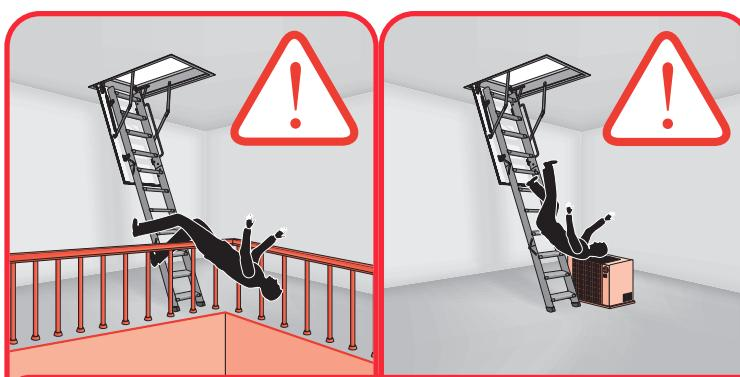
Il est déconseillé d'installer l'escalier escamotable à proximité des escaliers, des cages d'escalier ou des objets librement installés dans la pièce (par ex. la poêle).
