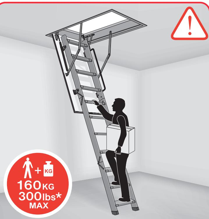
Die maximal zulässige Gesamtbelastung der Bodentreppen beträgt 160 kg (Gewicht des Nutzers plus etwaige Zusatzlasten). Jede zusätzliche bzw. darüber hinausgehende Belastung kann zu Schäden an der Bodentreppen und zu ernsthaften Personenschäden führen.
