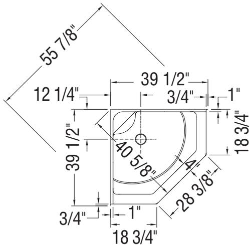
Toutes ces dimensions sont approximatives. Afin d'assurer une installation parfaite, les dimensions de la structure doivent être vérifiées à partir de l'unité.
