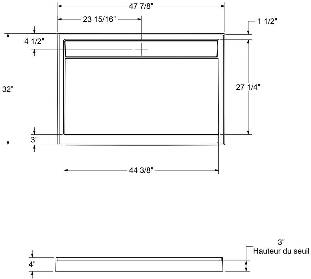
Toutes ces dimensions sont approximatives. Afin d'assurer une installation parfaite, les dimensions de la structure doivent être vérifiées à partir de l'unité
